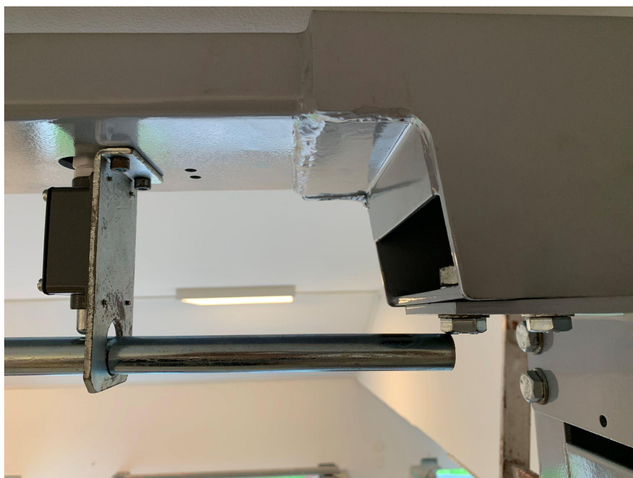
Stångens längd är för lång och tar i tvärbalken, kapa bort ca 50mm.
