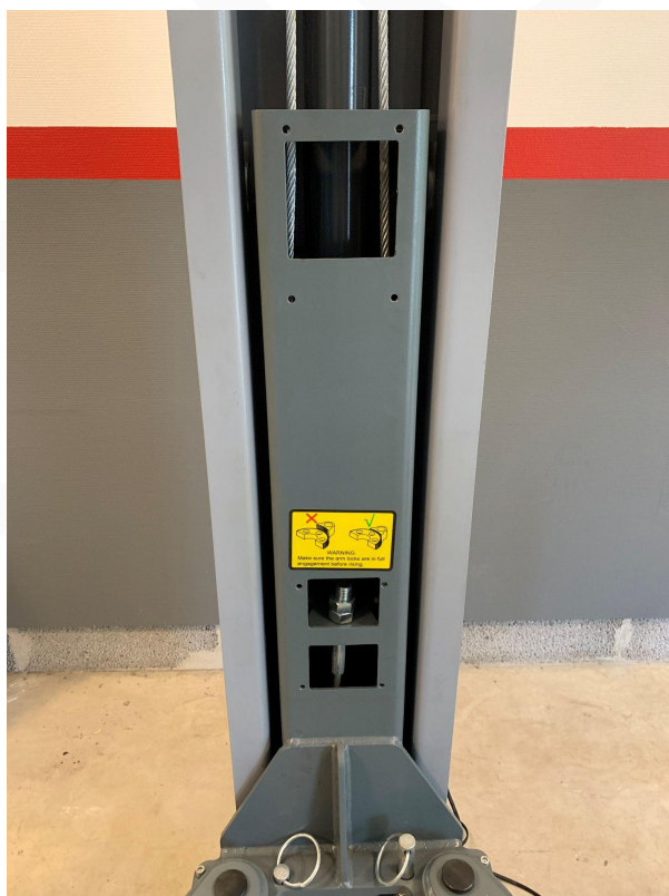
Vajer monterad när lyften är i högsta läget.
