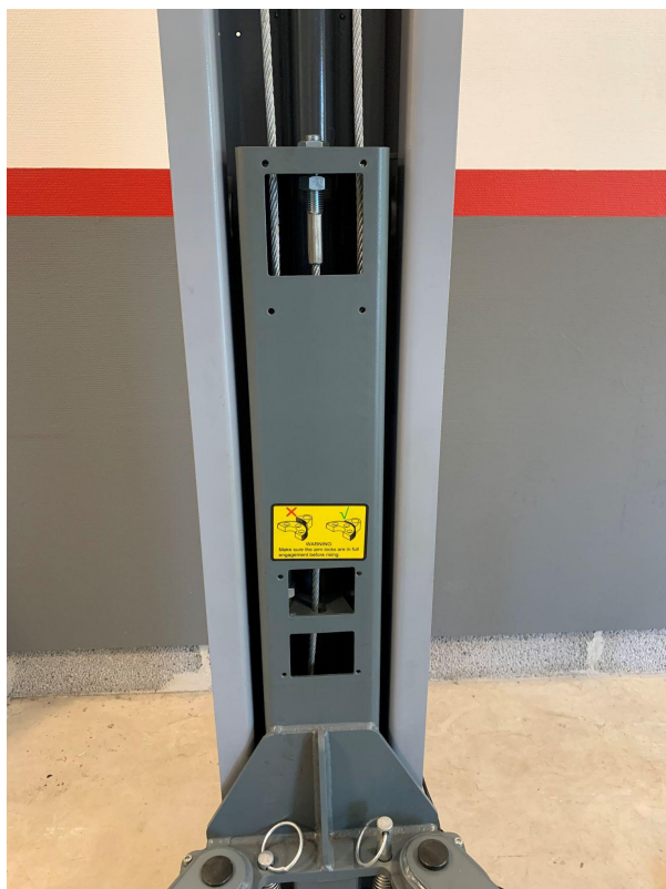
Vajer monterad när lyften är i lägsta läget.
