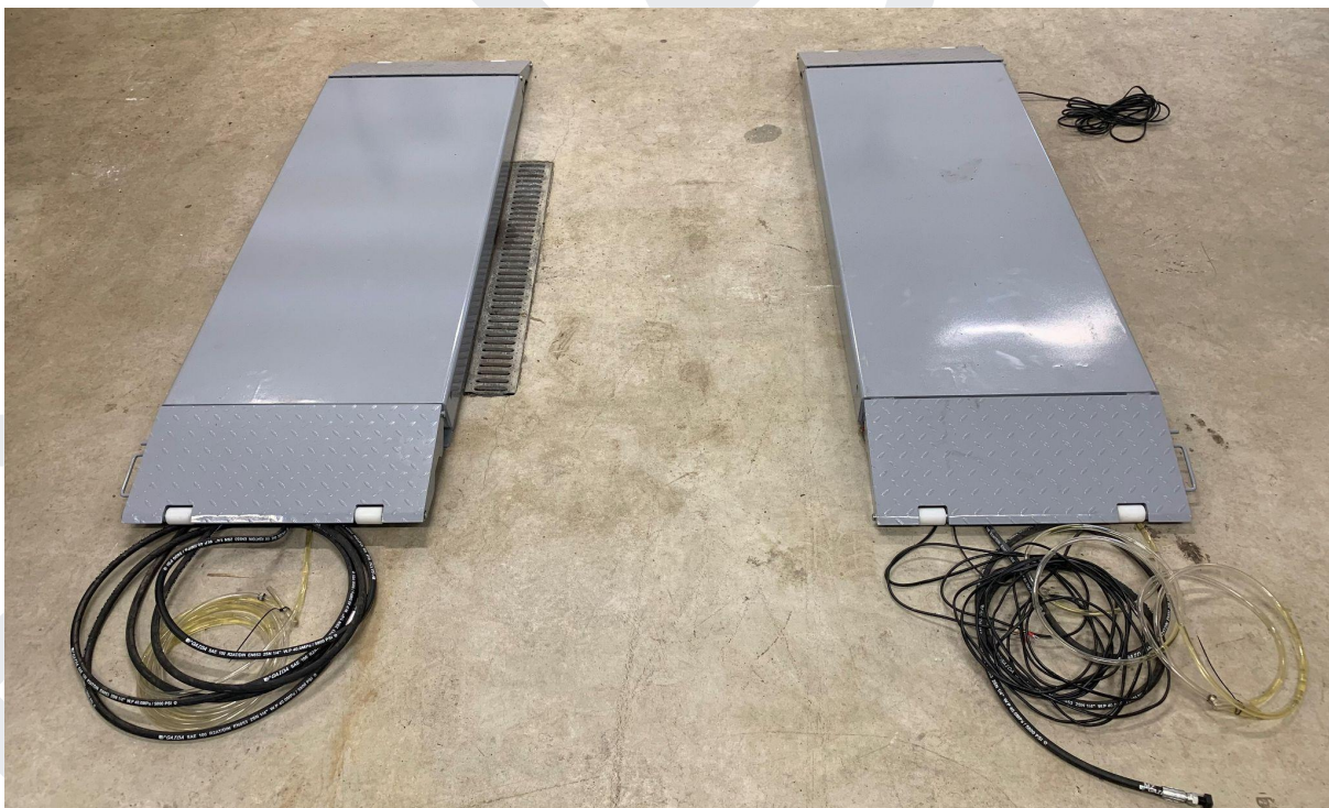
Underplattformen med slangar (till vänster) & huvudplattformen med slangar & givarkablar. (till höger)
