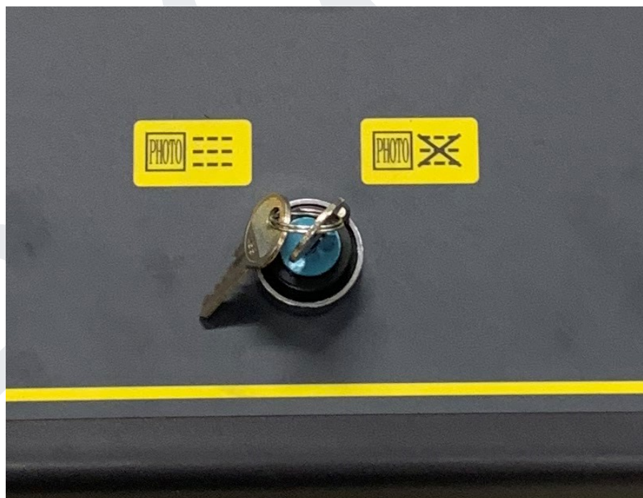
Av- och påslag för fotocell sensorn sitter på manöverboxen.
