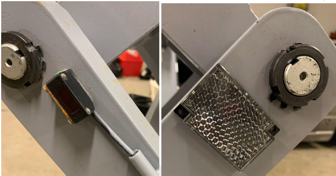
Fotoelektriska säkerhetsstoppen skickar signal via reflex till manöverboxen.
