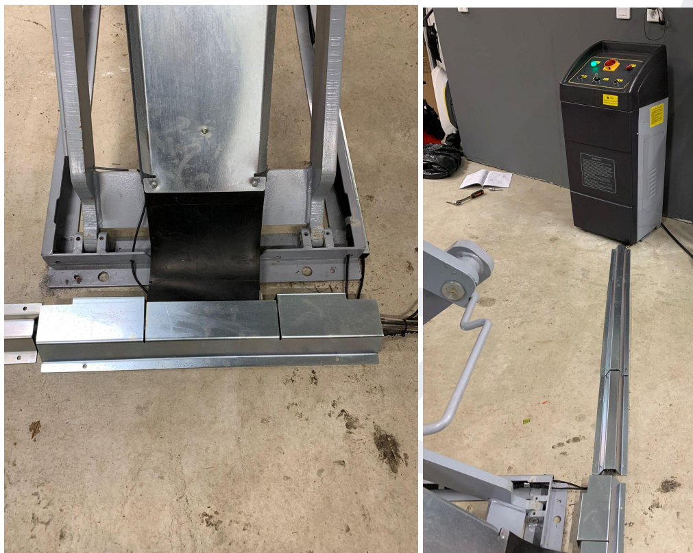
Täckplåt vid plattform (bild till vänster) och täckplåt till manöverbox (bild till höger)
